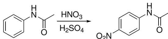
Figura 1: Esquema da reação entre a acetanilida e uma mistura de \text{H}_2\text{SO}_4 e \text{HNO}_3 , resultando na formação da 4-nitroacetanilida.
